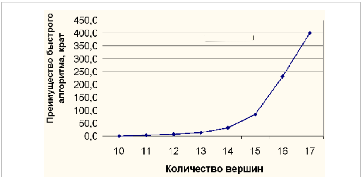
Рис. 32-16 — Отношение скорости быстрого алгоритма к скорости точного алгоритма ( T_1/T_2 )
