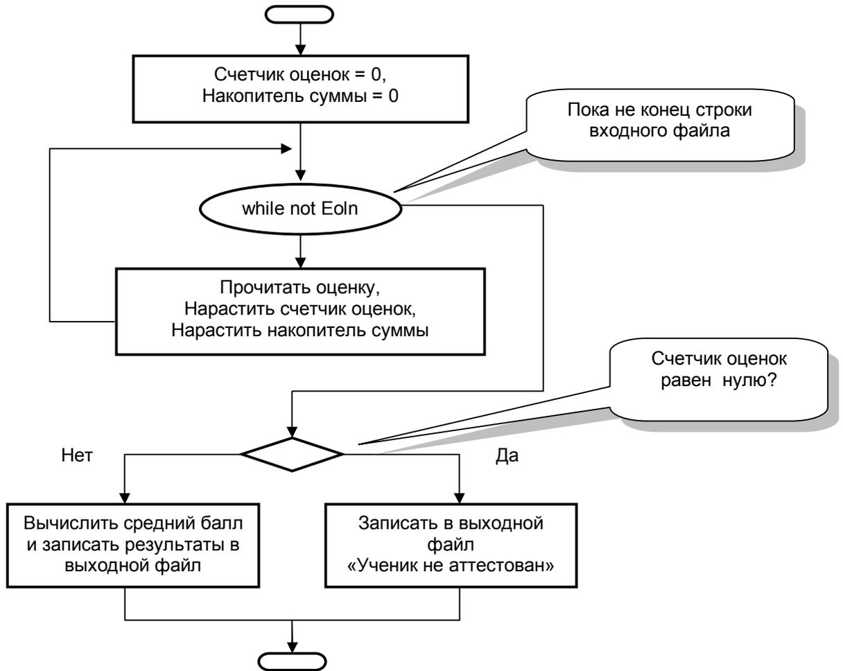
Рис. 69 – Блок-схема обработки одной строки входного файла
