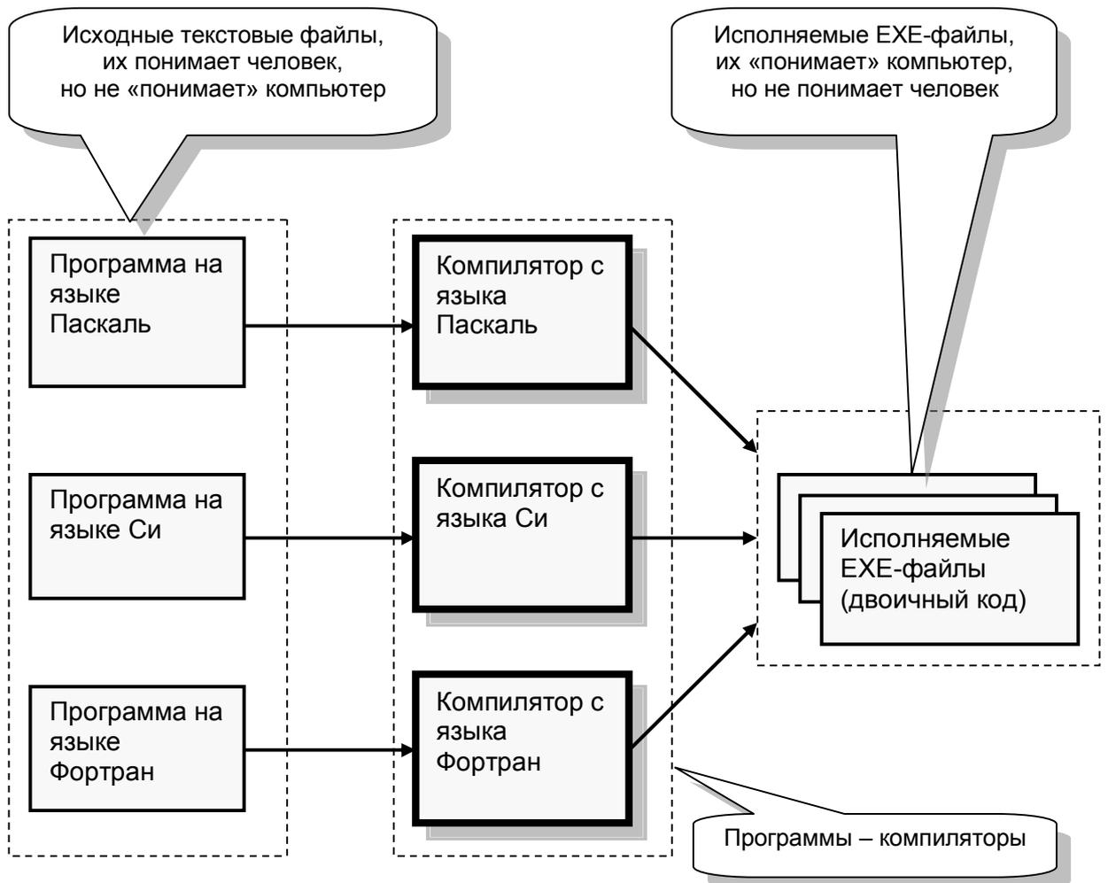
Рис. 2 – Схема применения компиляторов
