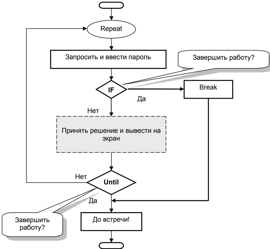
Рис. 30 – Блок-схема циклической программы с оператором Break
