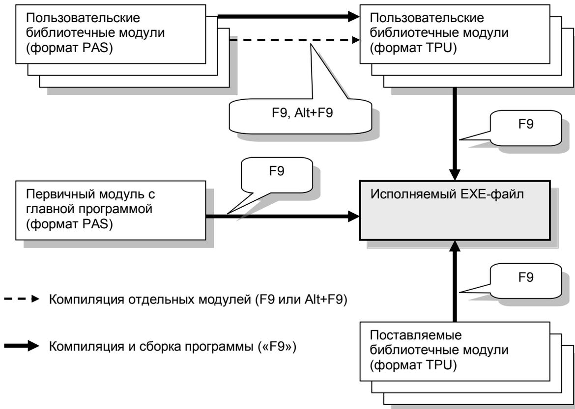
Рис. 149 – «Цех» компиляции и сборки проекта
