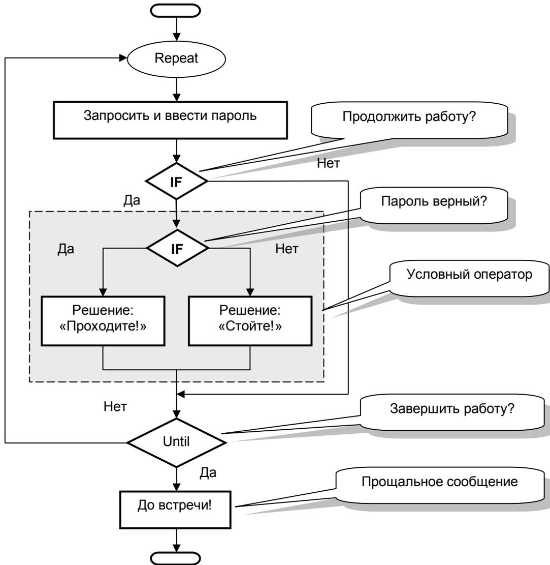
Рис. 29 – Блок-схема часового с корректным завершением
