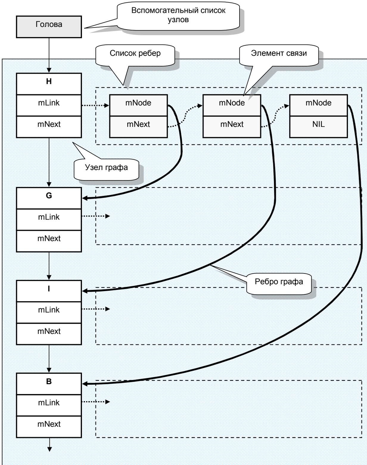
Рис. 134 – Организация связей графа на примере узла **H**
