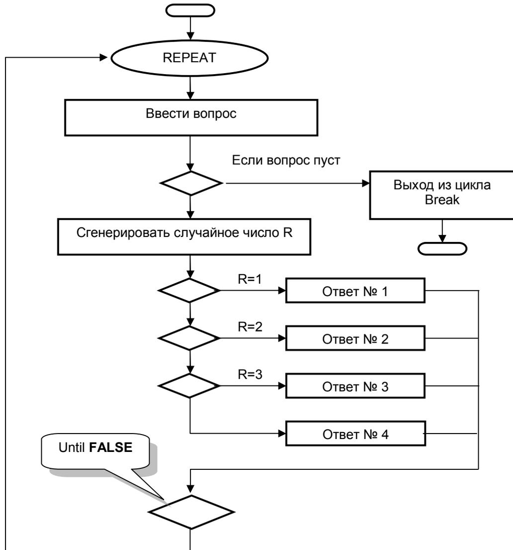
Рис. 38 – Блок-схема выбора из четырех вариантов
