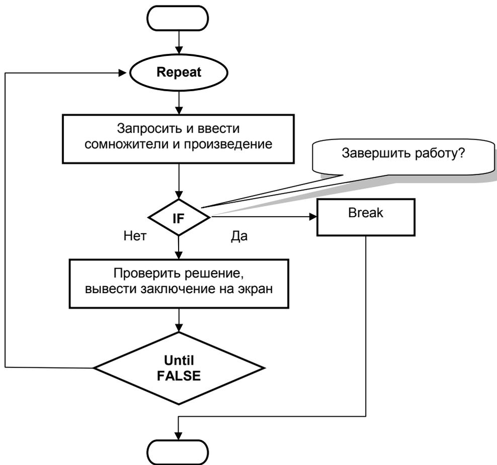
Рис. 37 – Блок-схема программы проверки таблицы умножения
