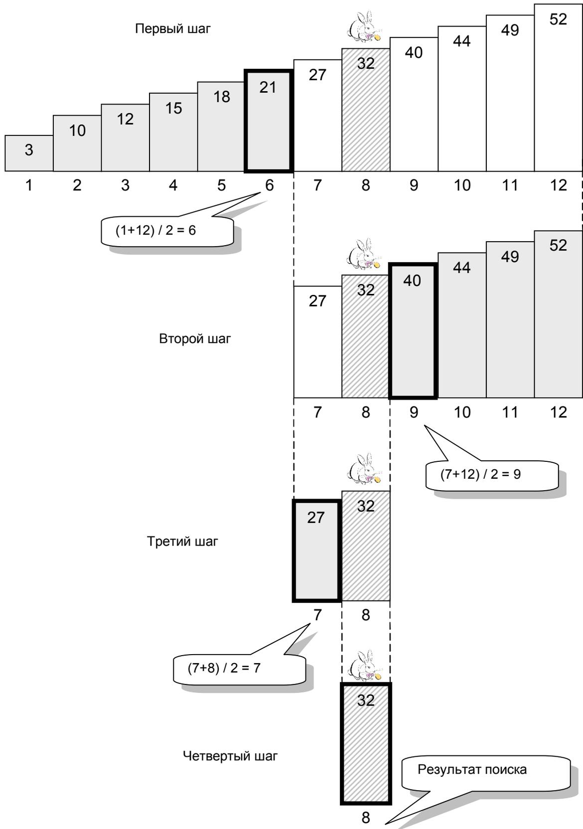
Рис. 91 – Двоичный поиск в отсортированном массиве
