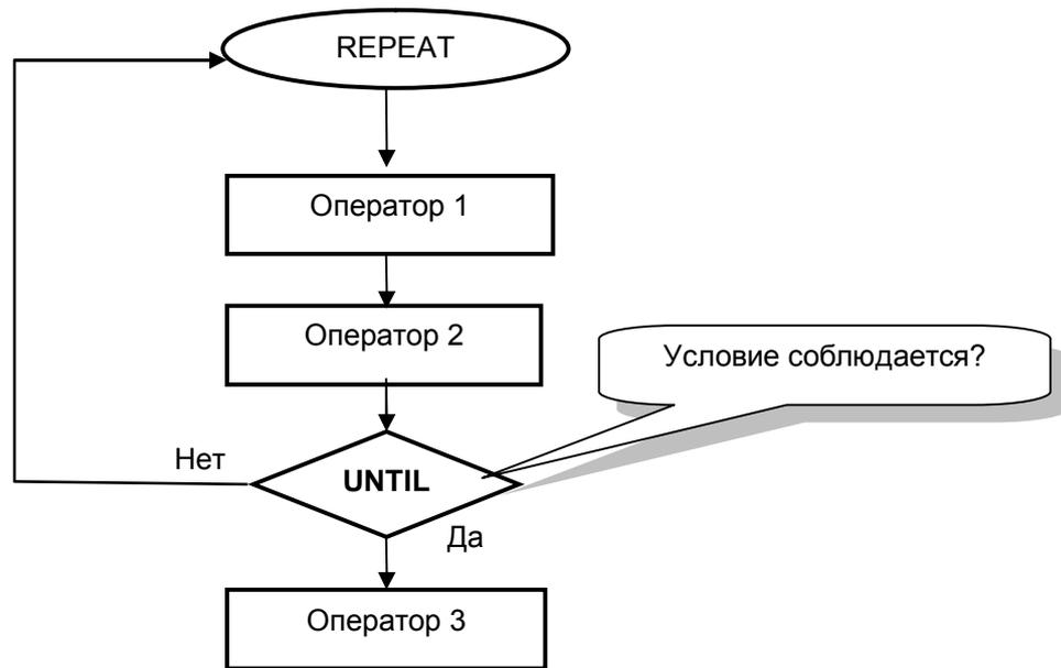
Рис. 28 – Блок-схема оператора цикла с проверкой в конце
