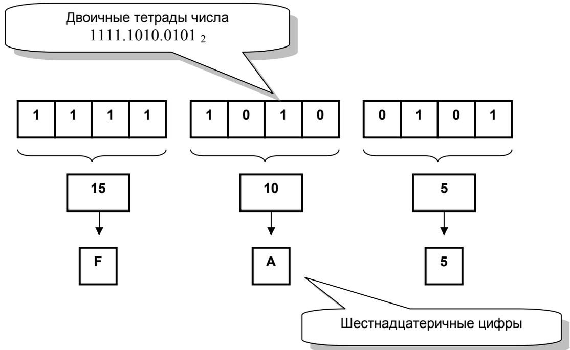
Рис. 107 – Преобразование двоичного числа в шестнадцатеричное
