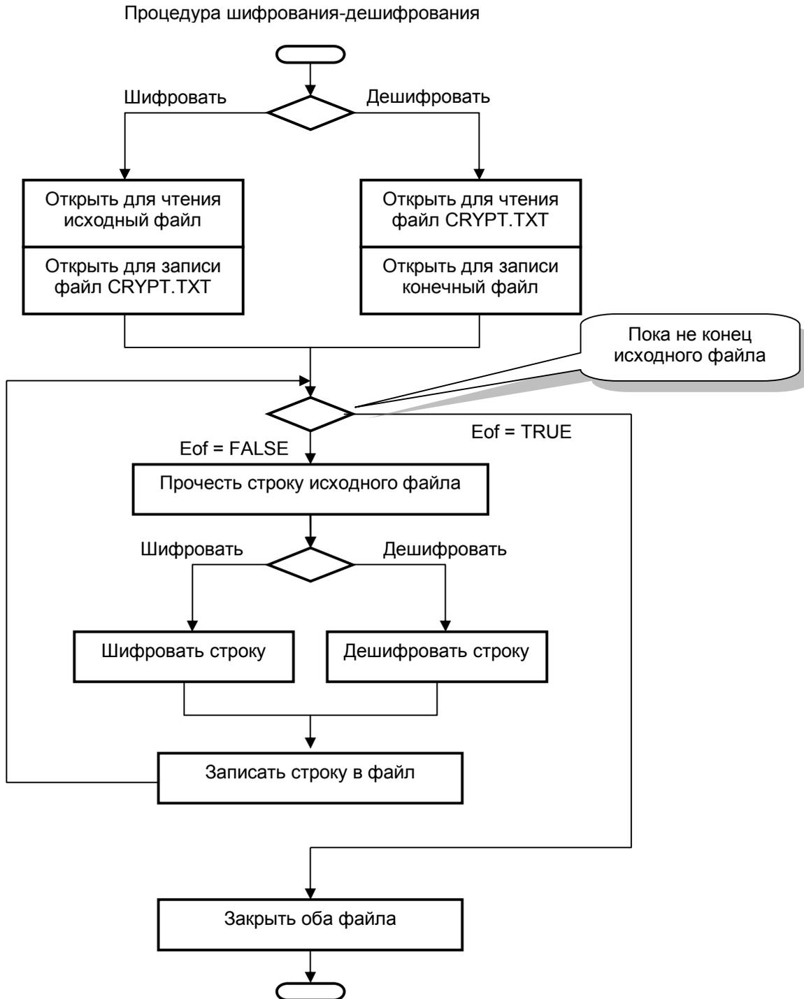
Рис. 59 – Блок-схема процедуры шифрования-расшифровки
